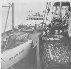
THE AMMONIA converter's 120-ton mass is transferred from the Pericles to the Inagua Wave, a converted LSM. E CONVERTIDOR di amoníaco di 120 ton ta wordé descargá for di Pericles pa Inagua Wave, un barco di desembarque.
